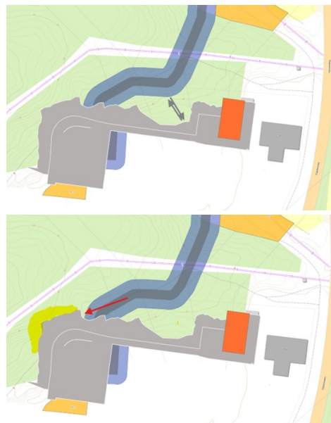
Figur 2. Øverst: Adkomsttrasé ved Bardufoss transformatorstasjon vist med grå piler. Nederst: Område som er sikret vist i gult. Kilde: Arva, e-post av 17. august 2026.
